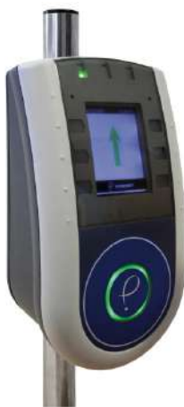
Figura 3 – Validador do passe sem contacto com luz verde respeitante a um título válido
