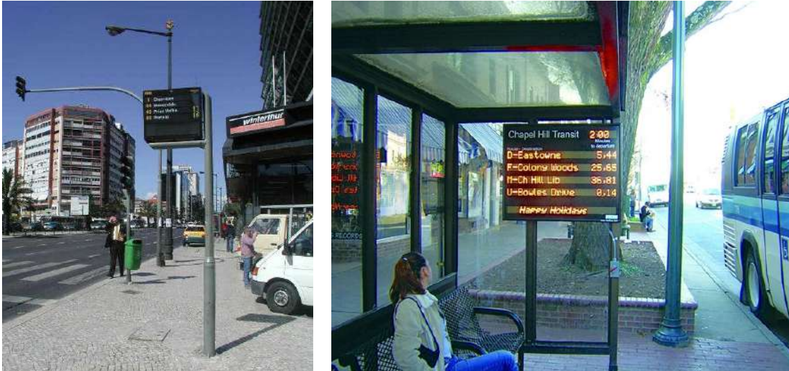
Figura 4 – Painéis de informação dinâmica nas paragens: fora do abrigo (esq.) e dentro do abrigo (dir.)
